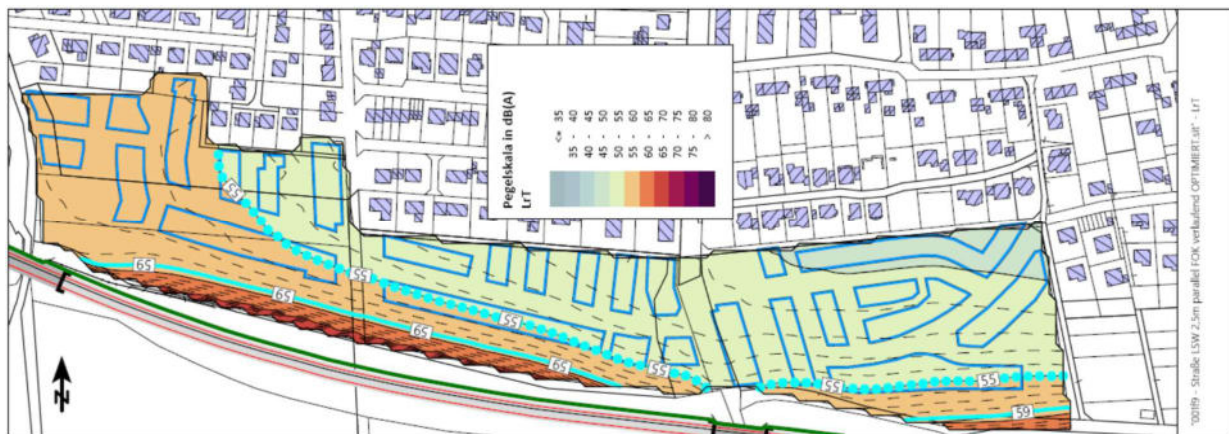
Immissionswerte mit Lärmschutzwand ( dunkelgrün, unterschiedlicher Höhe ) tags (6:00 bis 22:00 Uhr), 2. Obergeschoss
