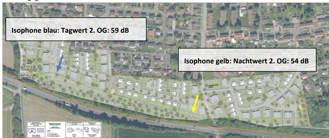
Abb. städtebaulicher Entwurf m. Lärmisophonen (54 dB nachts (gelb)/59 dB tags blau) und Lärmschutzwand im Abstand von 5,0 m zum Fahrbahnrand (rot)
